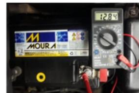
Evidencie a necessidade de substituição através de uma foto que mostrando a marca e a Tensão da bateria a ser substituída.
